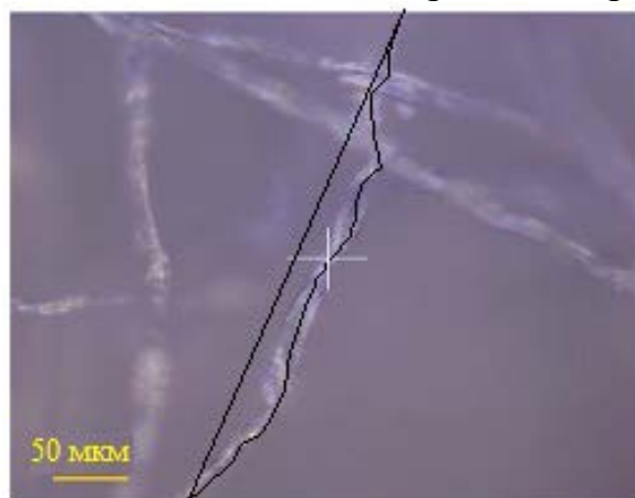
Рис. 2. Определение фактора формы синтетической целлюлозы (конфокальная микроскопия).
