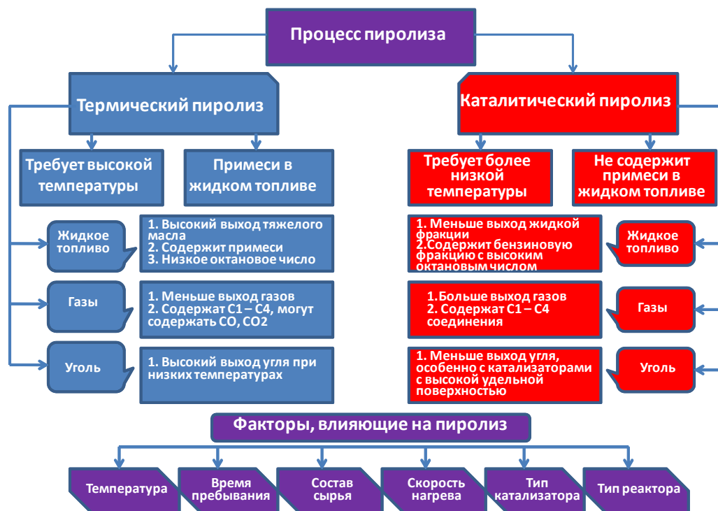
Рис. 9. Сравнение основных показателей термического (некаталитического) и каталитического процессов пиролиза пластиковых отходов.
