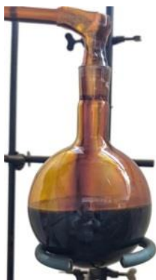
Рис. 2. Лабораторная установка для фракционированной вакуумной дистилляции смолистого тар-продукта при остаточном давлении 15–20 кПа
