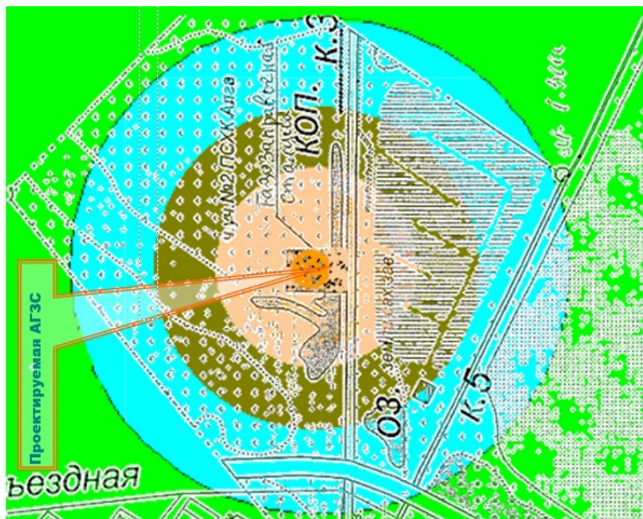
Рис. 3. Графическое отображение потенциального территориального пожарного риска на производственной площадке. ■ – 10^{-5} < R_{\Sigma} ; ■ – 10^{-6} < R_{\Sigma} < 10^{-5} ; ■ – 10^{-7} < R_{\Sigma} < 10^{-6} ; ■ – 10^{-8} < R_{\Sigma} < 10^{-7} ; ■ – 10^{-8} < R_{\Sigma}
