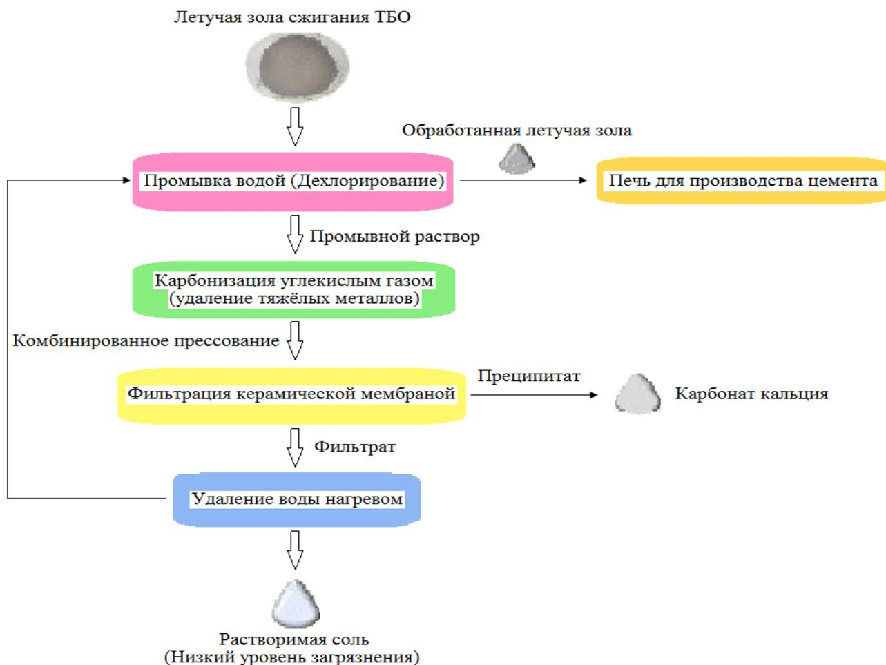
**Рис. 8.** Комбинированный способ детоксикации золы-уноса ТБО
