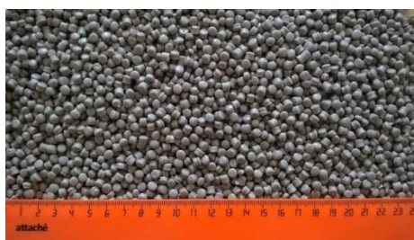
Рис. 1. Фото гранул вторичного полипропилена, полученного из лотков и ведер, производства ООО «ЭкоТехноМенеджмент», г. Кострома, Россия.
