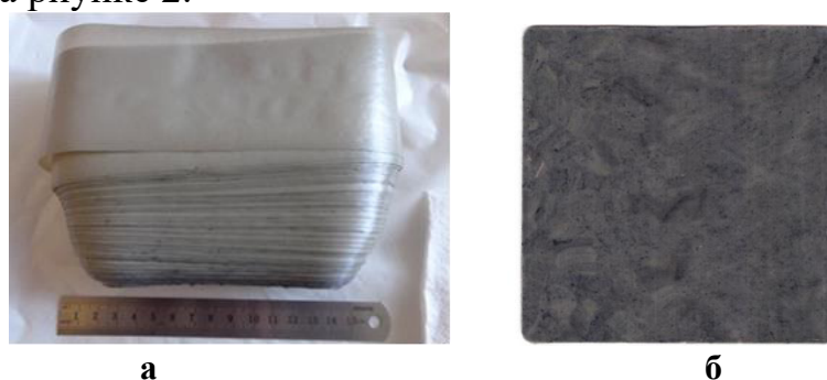
Рис. 2. Лабораторные образцы пленок на основе смеси ВтПП и POE SOLUMER 875L (10% масс.), полученные методом экструзии (а) и композита на основе ВтПП/MASFLEX (10% масс.) и АПДДРШ (2% масс.), полученного методом термопрессования (б) в масштабе 1 : 1.
