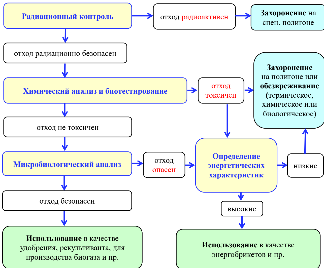
Рис. 1. Схема алгоритма выбора безопасного обращения с осадками, образующимися после биологической очистки сточных вод.
