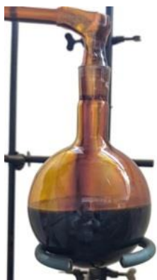
Рис. 2. Лабораторная установка для фракционированной вакуумной дистилляции смолистого тар-продукта при остаточном давлении 15–20 кПа
