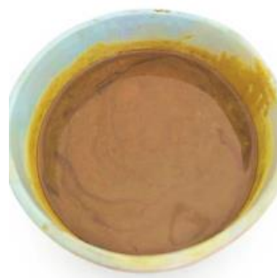
Рис. 3. Кристаллический продукт тетраценовой фракции, полученный после низкотемпературной кристаллизации при -5^{\circ}\text{C} (масса 503 г).
