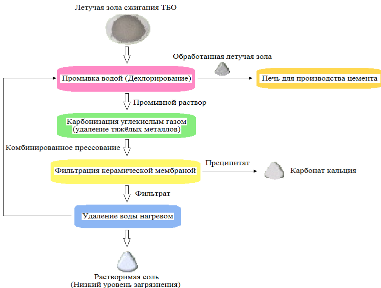
Рис. 8. Комбинированный способ детоксикации золы-уноса ТБО
