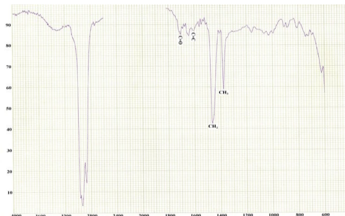
Рис. 4. ИК-спектр исходного образца искусственной нефти, полученной из НБП.
