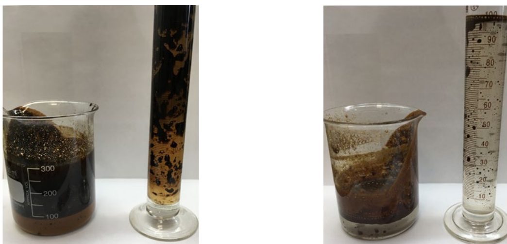
Рис. 1. Разделение фаз водонефтяной эмульсии скважины а – № 1, б – №2.
