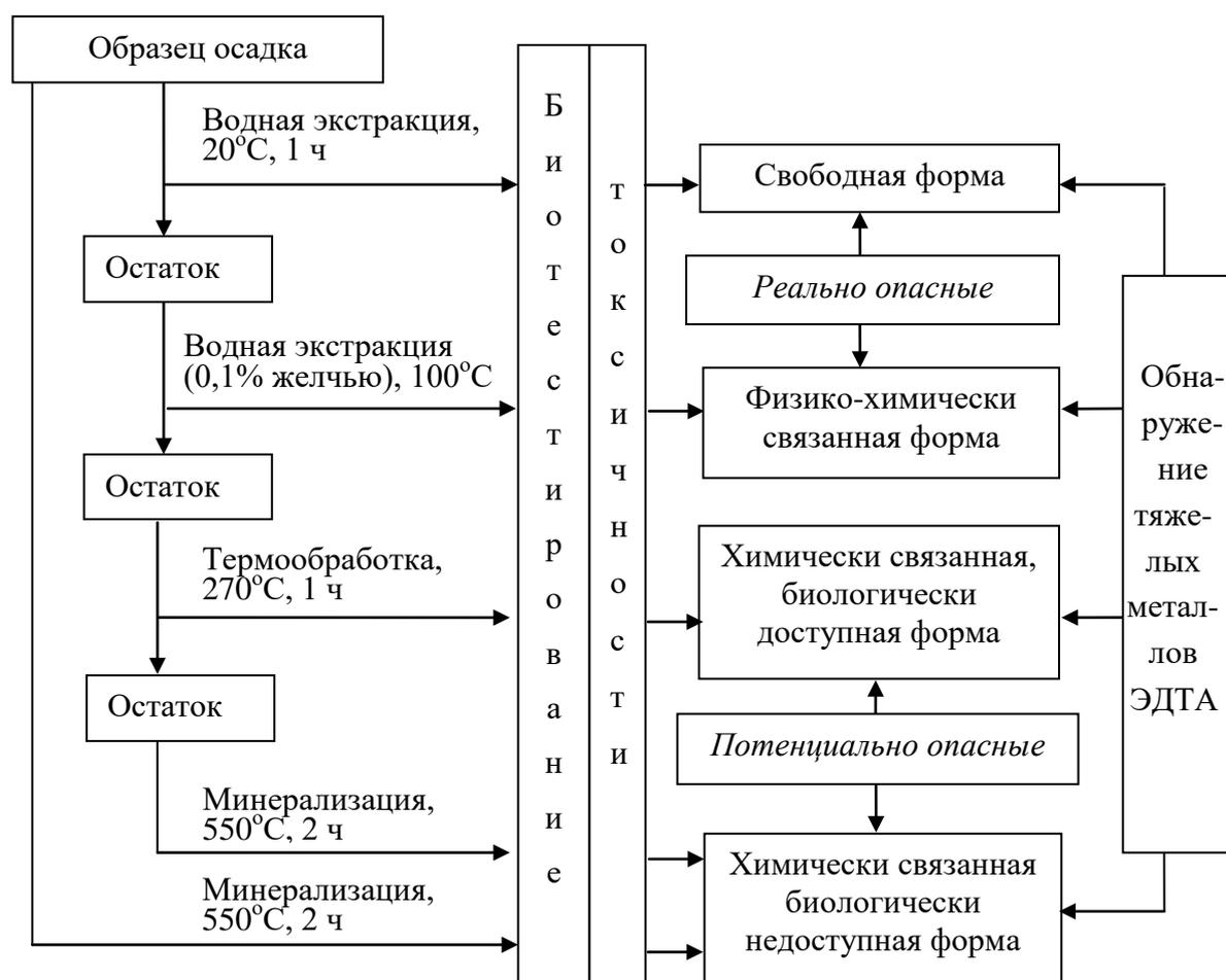
**Рис. 4.** Схема последовательной пробоподготовки для биотестирования токсичности осадков сточных вод.
