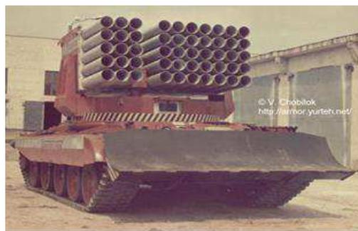
**Рис. 11.** Гусеничная пожарная машина «Импульс-2М».
