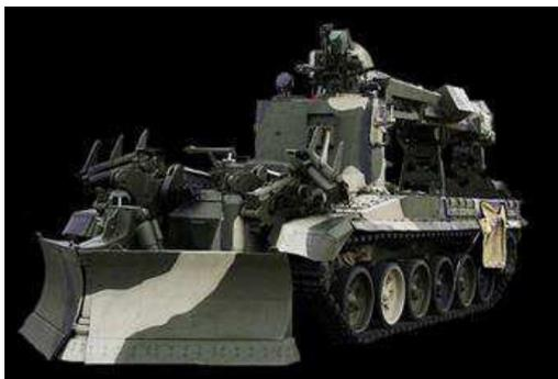
**Рис. 6.** Инженерная машина разграждения ИМР-3.
