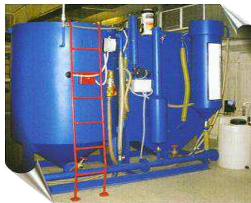
**Рис. 22.** Блочно-модульная установка очистки воды.
