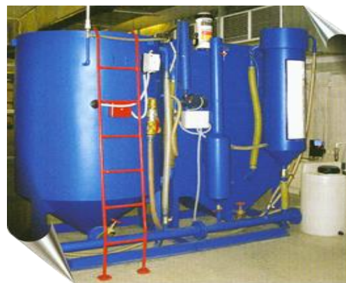
Рис. 22. Блочно-модульная установка очистки воды.
