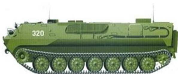
Рис. 13. Многоцелевой гусеничный плавающий транспортер-тягач легкой категории.
