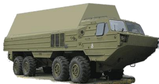
Рис. 14. ППУ на базе автомобиля БАЗ-69501. Шасси Брянского автомобильного завода.
