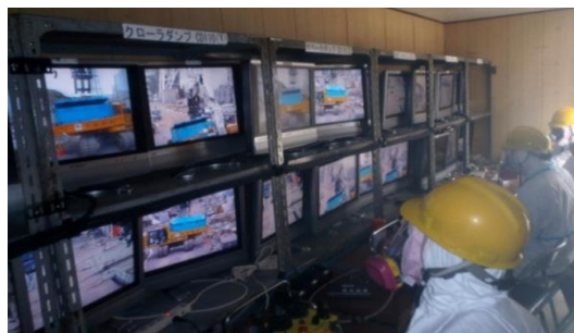
Рис. 2. Пункт дистанционного управления робототехническими средствами при ликвидации аварии на АЭС «Фукусима» в Японии в 2011 г.
