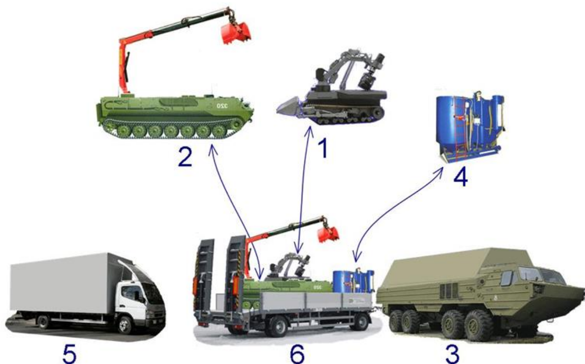
Рис. 12. Мобильный робототехнический комплекс: 1 - ЛРТС; 2 - СРТС; 3 - ППУ; 4 - блочно-модульная установка для очистки воды; 5 - автомобиль-дегазатор ОВ; 6 - низкорамный прицеп.
