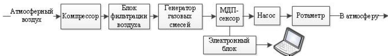
**Рис. 3.** Блок-схема экспериментальной установки для исследования чувствительности МДП-сенсоров к аммиаку, сероводороду, этилмеркаптану, диоксиду азота.
