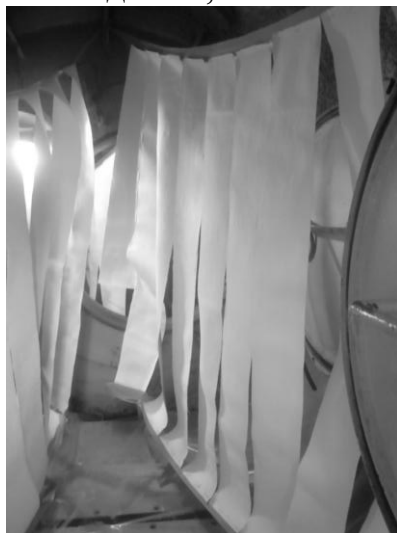
Рис. 8. Размещение образцов листового хемосорбента в герметичной камере.
