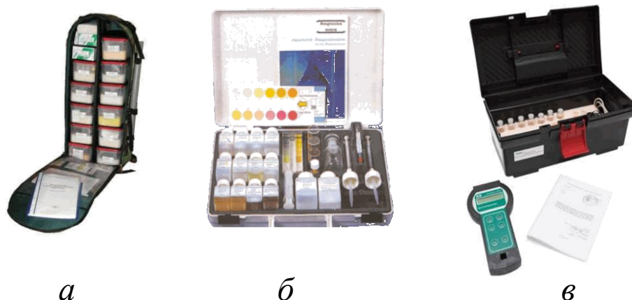
Рис. 1. Примеры серийных образцов отечественных и зарубежных технических средств контроля химических показателей качества воды: а – войсковая укладка-лаборатория полевого химического контроля «УКВ»; б – индикаторный набор Aquamerck – Merck; в – фотоколориметр Экотест 2020.
