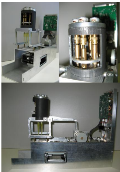
Рис. 6. Макетный образец многоканального капельно-сканерного колориметра.
