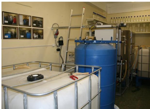
Рис. 24. Макетный образец блочно-модульной установки по очистке и обезвреживанию сточных вод и источников водоснабжения от нефтепродуктов, оборудованной системой автоматического управления технологическим процессом водоочистки с контролем ее качества.
