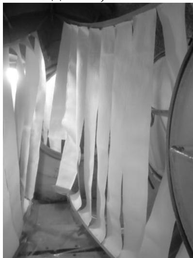
**Рис. 8.** Размещение образцов листового хемосорбента в герметичной камере.
