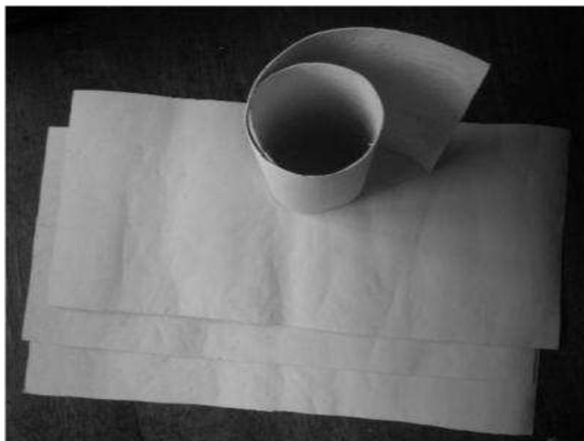
**Рис. 6.** Внешний вид листового хемосорбента с полимерным связующим.
