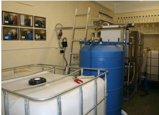
**Рис. 24.** Макетный образец блочно-модульной установки по очистке и обезвреживанию сточных вод и источников водоснабжения от нефтепродуктов, оборудованной системой автоматического управления технологическим процессом водоочистки с контролем ее качества.
