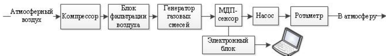
Рис. 3. Блок-схема экспериментальной установки для исследования чувствительности МДП-сенсоров к аммиаку, сероводороду, этилмеркаптану, диоксиду азота.
