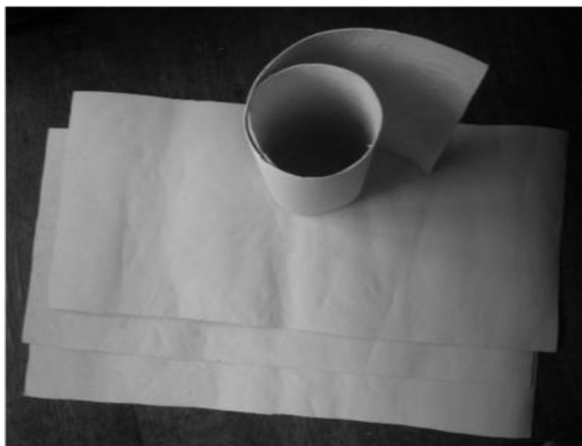
Рис. 6. Внешний вид листового хемосорбента с полимерным связующим.
