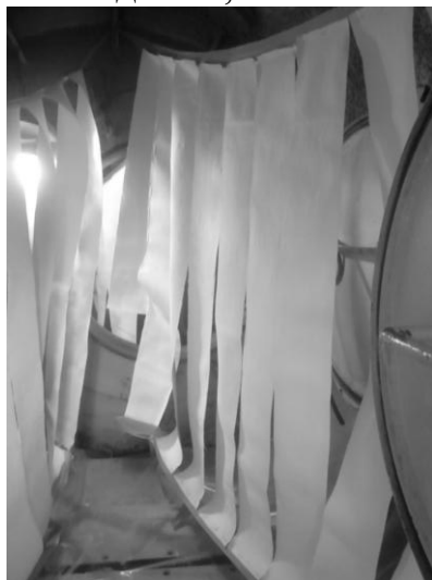
Рис. 8. Размещение образцов листового хемосорбента в герметичной камере.
