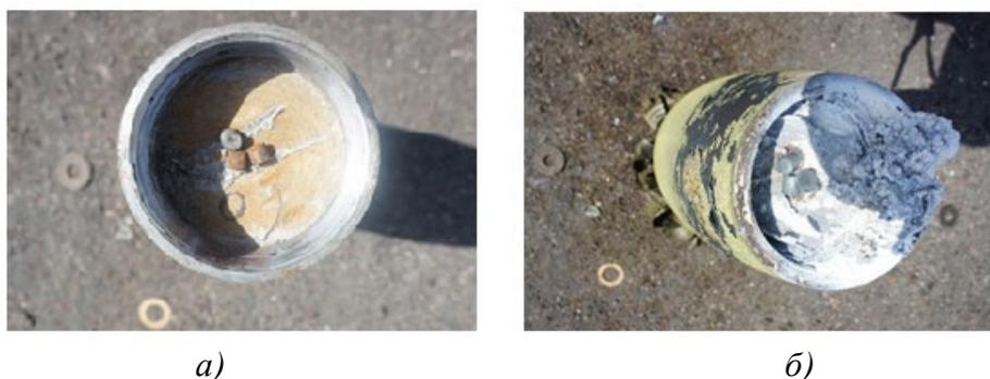
**Рис. 5.** Выжигание заряда ВВ при использовании гранул из безгазового теплоинерционного теплового состава.
