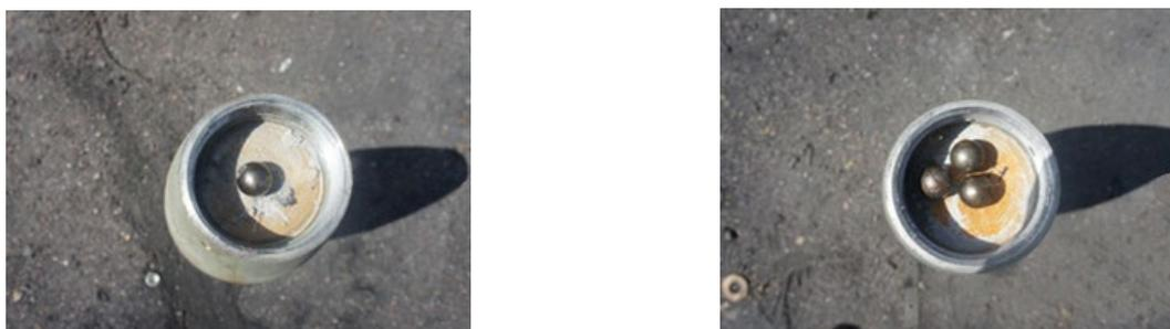
**Рис. 4.** Сборки расснаряжаемых снарядов с лидирующими элементами в виде металлических шаров.
