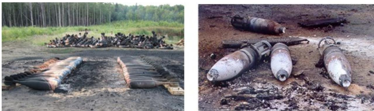
**Рис. 1.** Вид площадки сжигания после выжигания взрывчатого наполнения из боеприпасов
